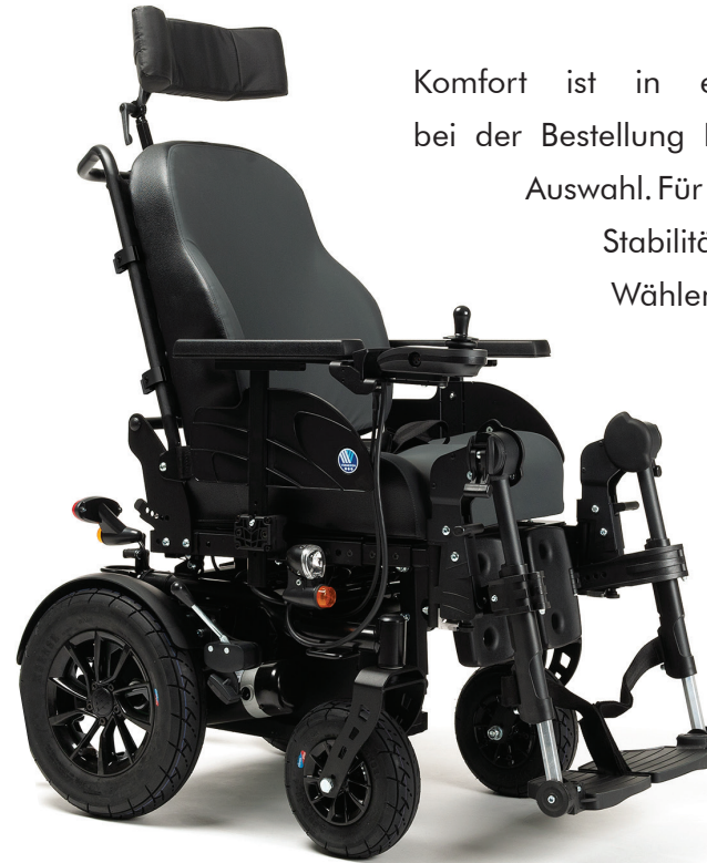
Turios C5 schwarz Kopfstütze L55 LED-Fahrlicht und Blinker SE 19 Beinstütze Winkel und Längenausgleich verkürzt BZ8
